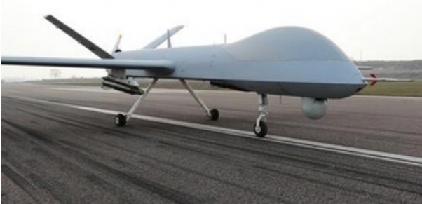
Le drone chinois Wing Loong II, l'un des principaux drones MALE (moyenne altitude, longue endurance) proposés à l'exportation par la Chine. Source : https://en.avic.com/
