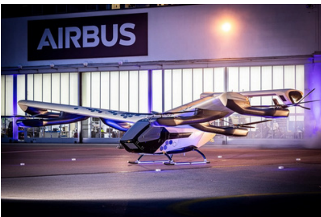
CityAirbus NextGen, prototype d'eVTOL entièrement électrique, à quatre places, a été développé par Airbus et présenté en 2024. Mais, en 2025, le patron d'Airbus Helicopters, a annoncé suspendre le programme commercial au vu des incertitudes concernant les batteries. © Airbus
