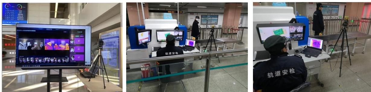
Caméra infrarouge et système de mesure de la température sans contact par assistance d'une intelligence artificielle dans chaque entrée du métro. Possibilité de vérifier la température jusqu'à 15 personnes par seconde, ceci évite donc une vérification par thermomètre pour chaque passager.
