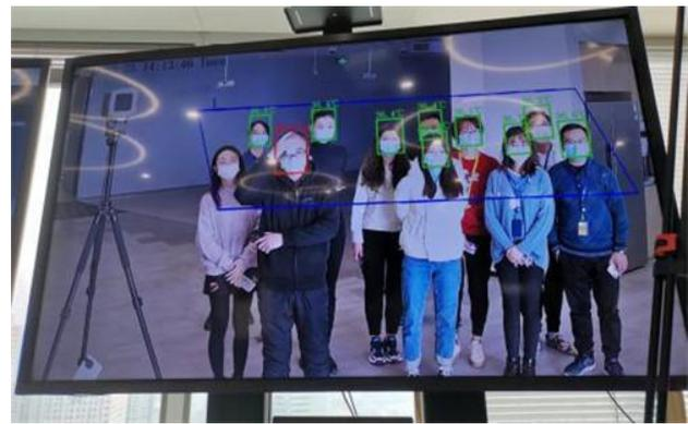
Prise de température de masse avec une précision de  $\pm 0.3^{\circ}\text{C}$
